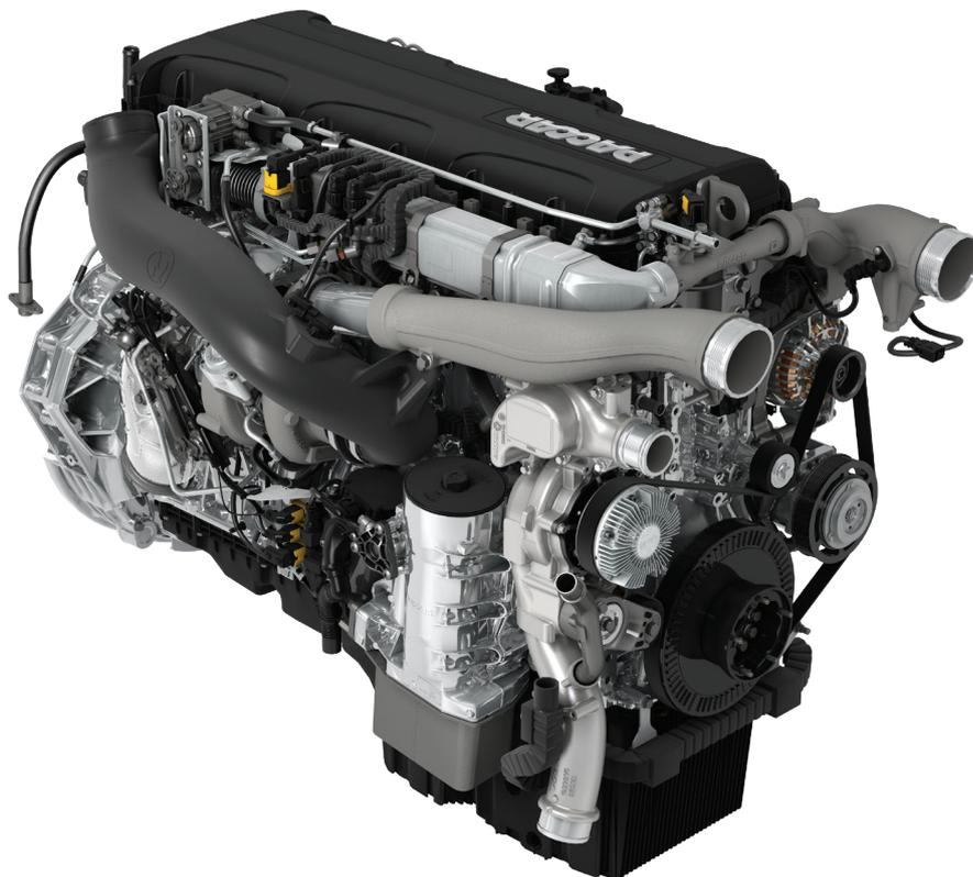
Двигатель PACCAR MX-11 Euro 6 объемом 10,8 литров использует сверхсовременную технологию впрыска с топливораспределительной рампой, турбонагнетатель с изменяемой геометрией и оптимизированную систему управления, обеспечивающую максимальную эффективность. Для соответствия жестким требованиям экологического стандарта Euro 6 двигатель оснащен системой рециркуляции отработавших газов, применяемой совместно с технологией SCR и активным сажевым фильтром.
